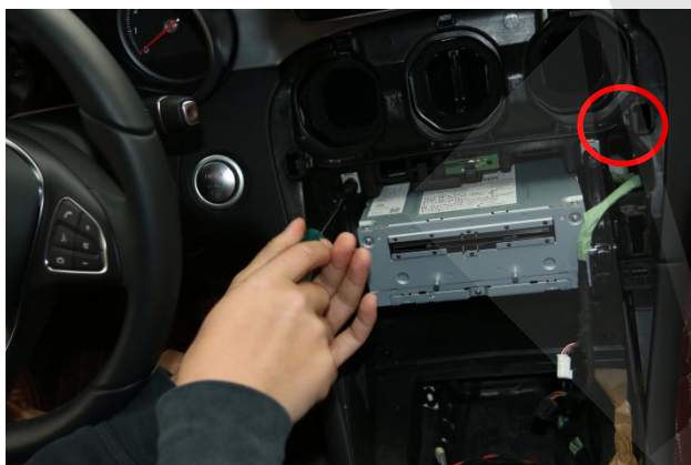
6. Vyšroubujte šrouby držící hlavní jednotku
